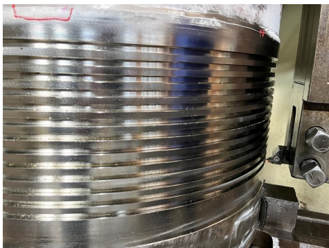
图4 迷宫密封焊接和加工
