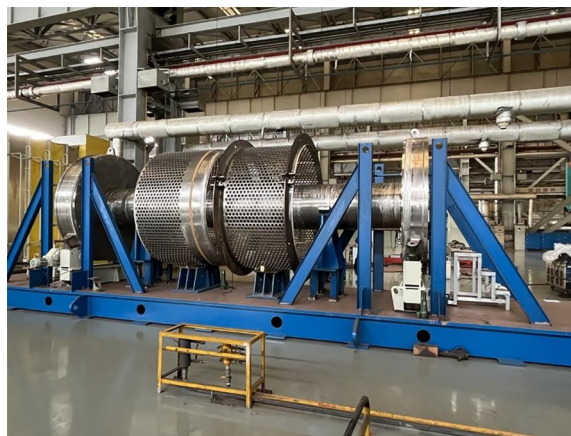
图5 管板与连接套筒装焊
